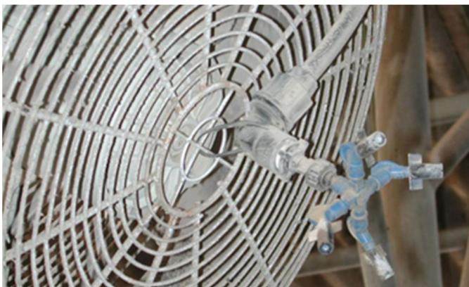
Bild 13. Vattenmunstycket avger små vattendroppar som blåses ut över korna. Foto: Delaval AB.
